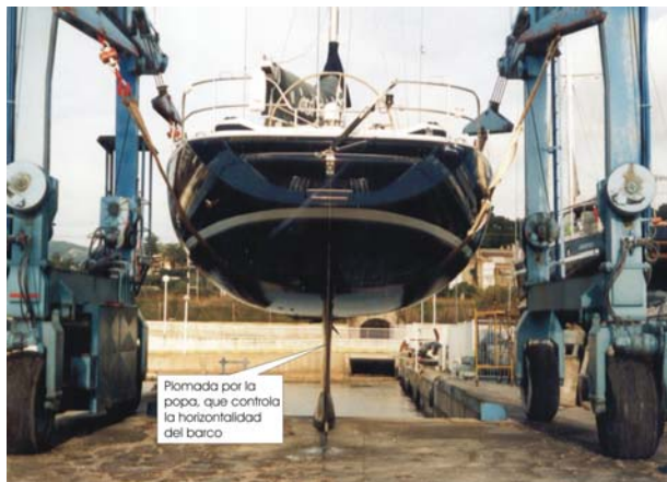
Imagen 15. Colocación cinchas en travelift
